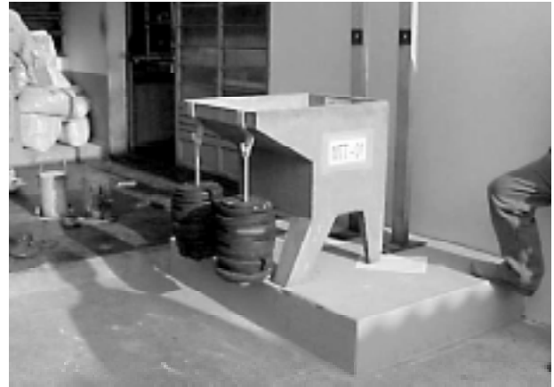
Fig.3 – Quando o teste foi aplicado neste tanque de pés inclinados o tombamento se deu com carga de 129,6 kgf chegando, em alguns modelos, a 205,1 kgf.
