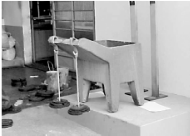
Figura 2: Teste realizado no laboratório da UEM, mostrando que no tanque de pés retos o tombamento ocorre com carga de apenas 18,5 kgf.
